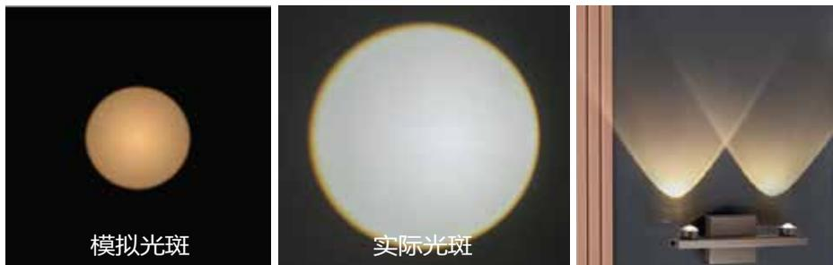
落日余晖：通过添加镀膜镜片，可以改变光斑颜色，达到不同的照明效果。
